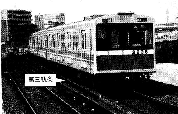
写真2-4 架線方式と第三軌条方式（上：架線方式の仙台市営南北線 下：第三軌条方式の大阪市営中央線）
