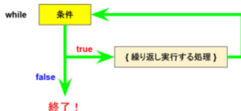
図 2-12 : whileは、条件をチェックし、trueならば処理を実行し、また元に戻る。falseになったら繰り返しを抜ける。
