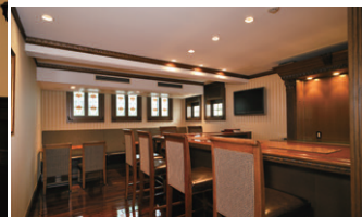
地下1階の照明 高演色のLEDダウンライトに更新
